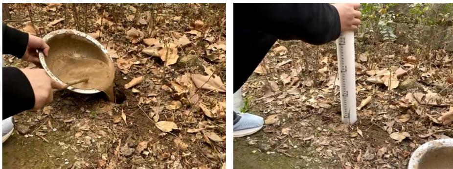
**注意：**下压过程应缓慢操作，不要向上拔传感器，避免气体进入孔洞影响测量。
